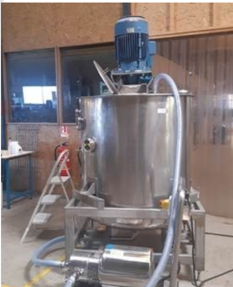
Machine de production capacité 1000 l de produit fini . Non ATEX
